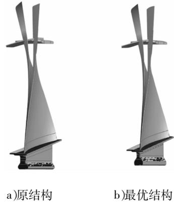
图 8 优化前后叶片的第一阶振型图
